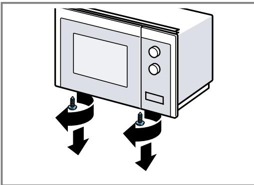
**5.** Fixer le cadre encastrable sur le fond du micro-ondes avec les deux vis extérieures.
