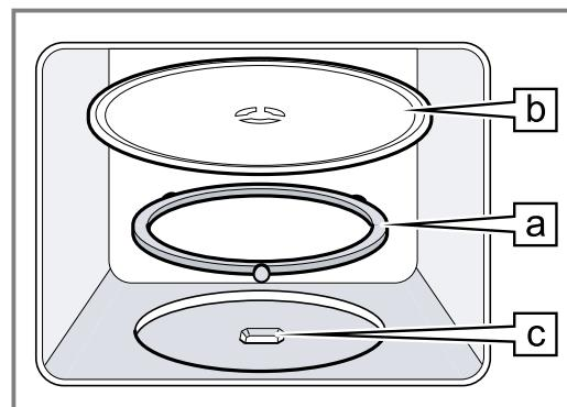
2. De draaischijf **b** in de aandrijving **c** in het midden van de bodem van de binnenruimte vergrendelen.
