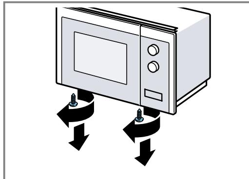
5. Het inbouwframe aan de bodem van de magnetron met de beide buitenste schroeven bevestigen.
